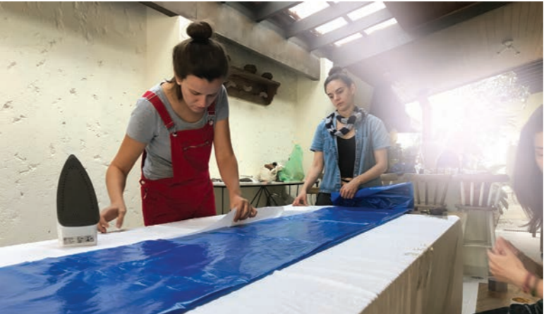
Fig.92. Montagem dos módulos da estrutura inflável. Os pedaços de plástico são fundidos através do uso de ferros de passar. (Fonte: acervo pessoal).
